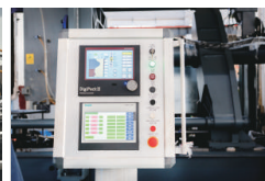
电脑控制系统 Digital Control System
