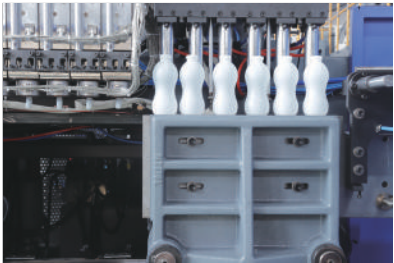
HT-六模头 HT-Triple Die Head
